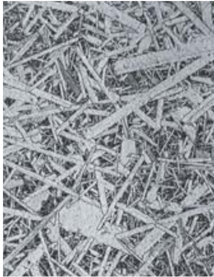
Korngröße 10 – 1500 µm, Dichte > 3,10 g/cm 3
