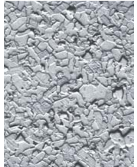
Mittlere Korngröße < 5 µm, Dichte > 3,16 g/cm 3
