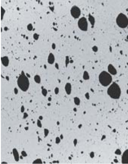
Mittlere Korngröße < 5 µm, Dichte > 2,76 -2,89 g/cm 3
