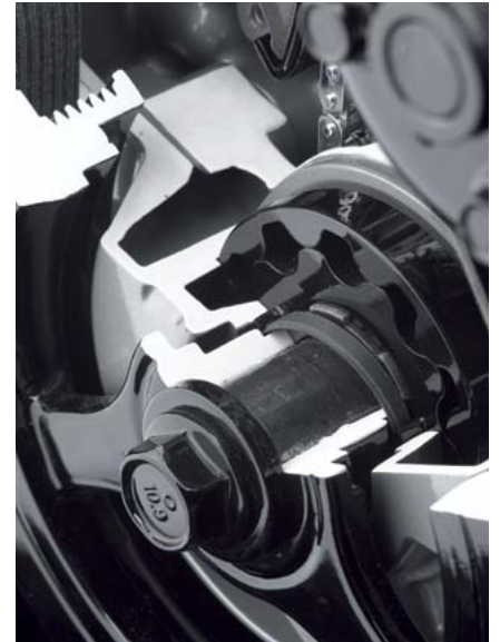
Calço de fricção EKagrip® montado no virabrequim do GM L5
