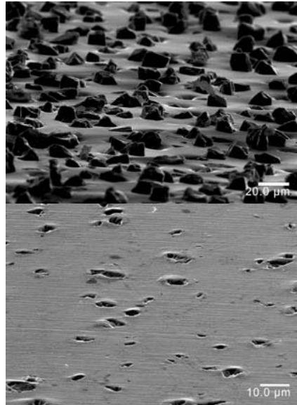
Fig. 2 Superfície de contato da junta de fricção com revestimento de fricção EKagrip® após montagem e desmontagem
