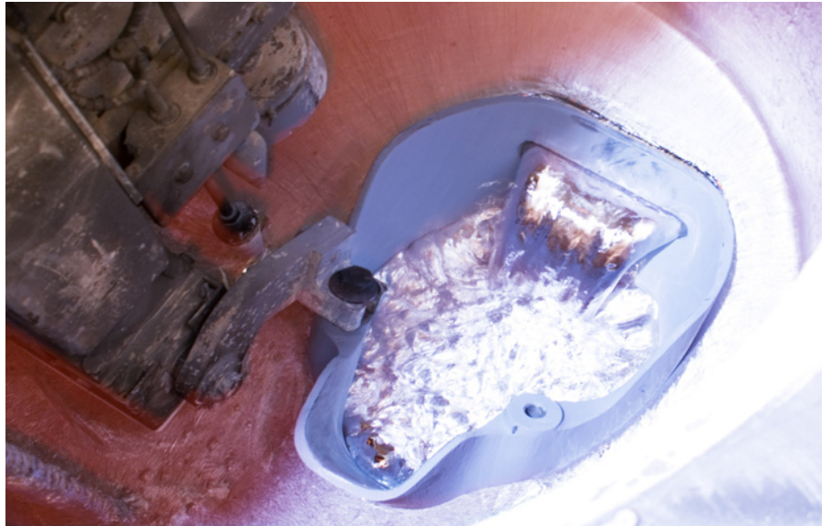
Mit EKamold® Cast-M beschichteter Gießlöffel im Einsatz
