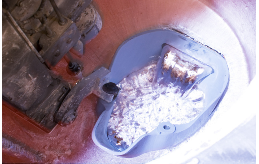
EKamold® Cast-Mをコーティングした使用中の铸造用ラドル
