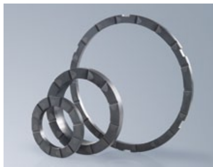
EKasic® 碳化硅激光加工滑动轴承（左：径向轴承，右：推力轴承），可用于重型化工泵、电磁耦合气密泵，以及化工和制药生产中的搅拌器。
