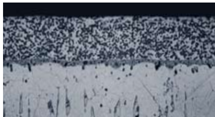
EKatex®涂层的横截面——无电镀镍金刚石型分布(2 μm)
