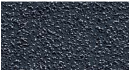
EKatex®涂层的SEM图像——无电镀镍金刚石型分布(2 μm)
