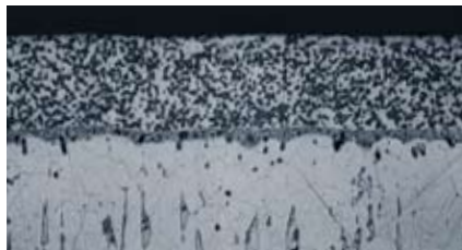
Querschliff EKatex® Beschichtung aus Chemisch Nickel Diamant (2 µm)
