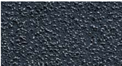
REM Oberflächentopographie EKatex® Beschichtung aus Chemisch Nickel Diamant (2 µm)
