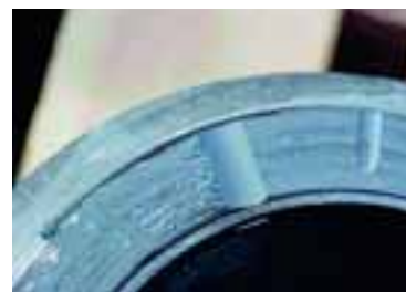
Überlastetes Axiallager aus Standard SSiC
