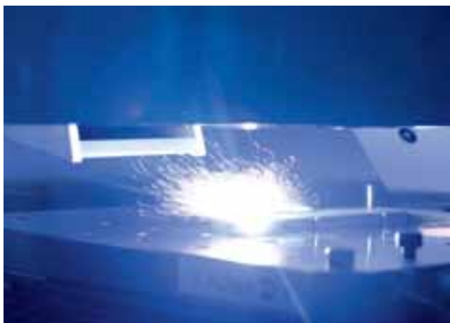
3D-Mikrostrukturierung mittels Nd:YAG-Laser (Foto: pro-micron GmbH & Co. KG)
