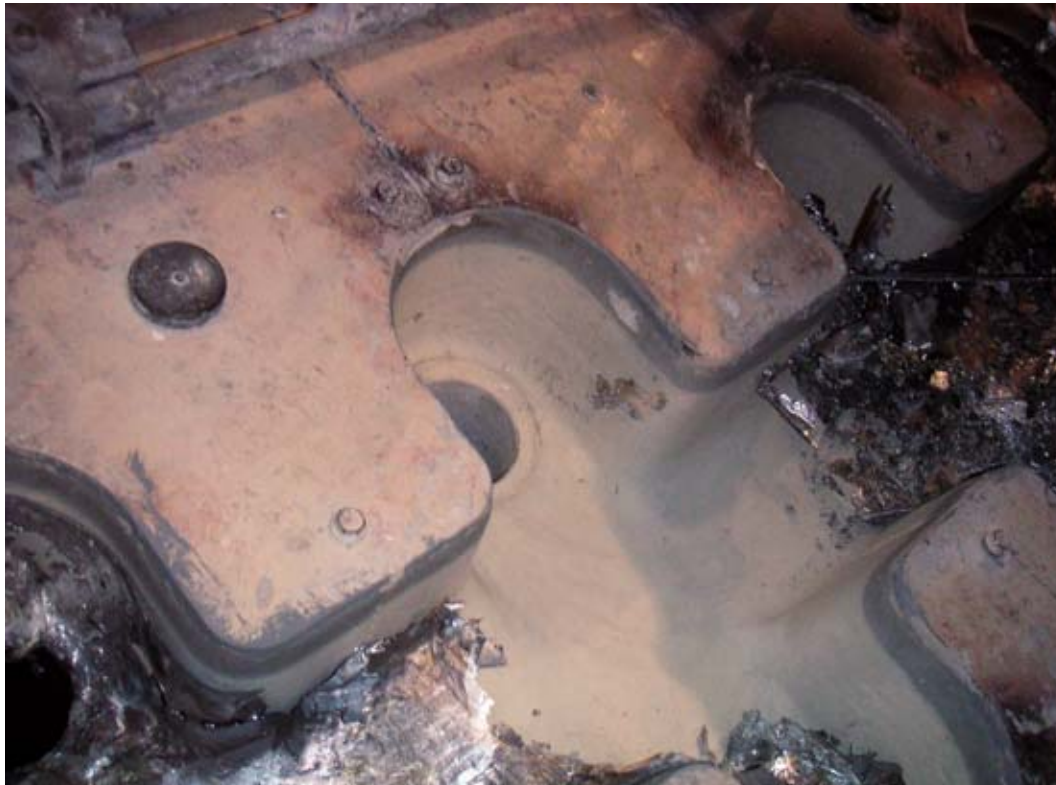
Bild 2: Gießtisch für Aluminiumbillet-Produktion beschichtet mit EKamold-Cast-C nach dem Einsatz
