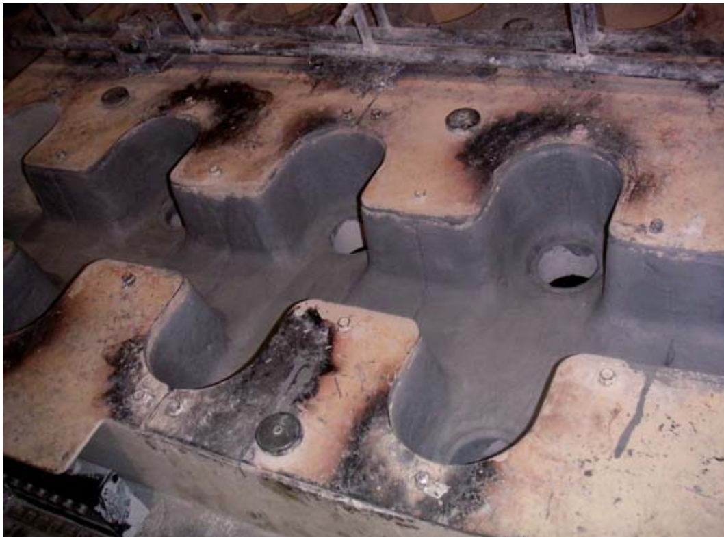
Bild 1: Gießtisch für Aluminiumbillet-Produktion, beschichtet mit EKamold-Cast-C vor dem Einsatz
