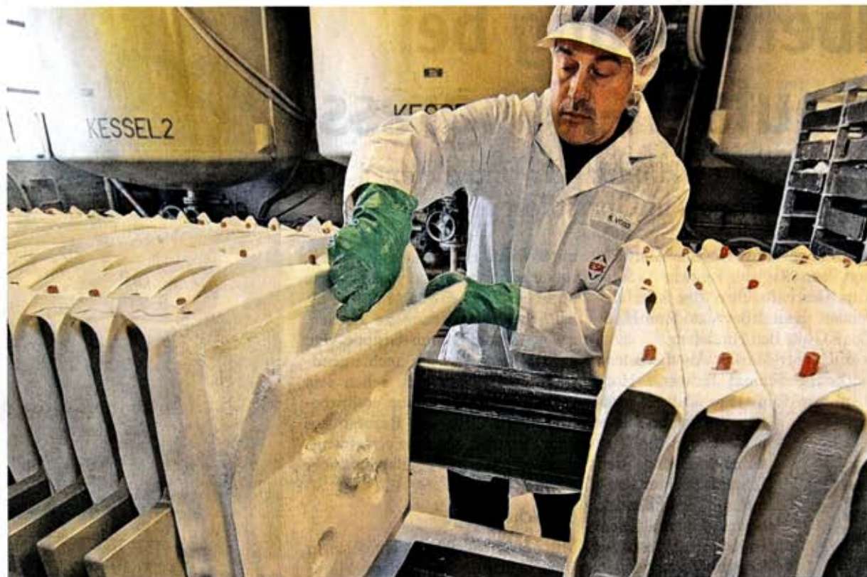
Blick in die Produktion des Elektroschmelzwerkes Kempten (ESK): Mitarbeiter Ralf Voß löst gewaschenes Bornitrid-Pulver zur Weiterverarbeitung aus der Kammerfilterpresse heraus.
