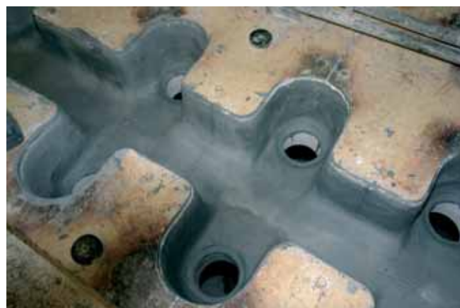
Bild 1. Gießtisch für die Aluminiumbillet-Produktion beschichtet mit EKamold® Cast-C vor dem Einsatz und dem ersten Abguss
