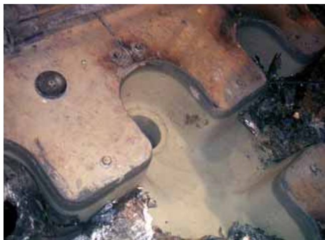
Bild 4. Gießtisch für Aluminiumbillet-Produktion beschichtet mit EKamold® Cast-C nach dem Einsatz
