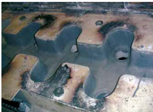
Bild 3. Gießtisch für Aluminiumbillet-Produktion beschichtet mit EKamold® Cast-C vor dem Einsatz
