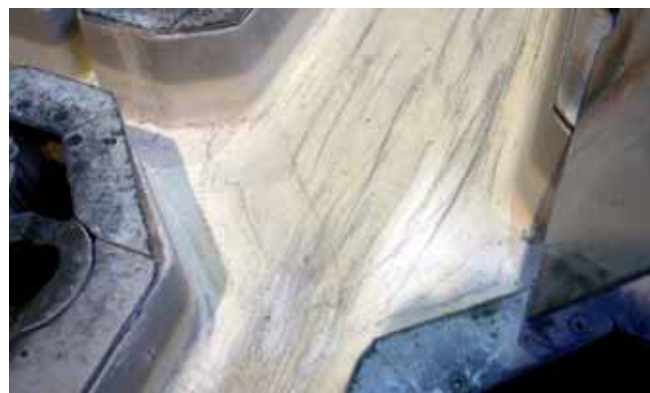
Bild 2. Gießtisch für die Aluminiumbillet-Produktion beschichtet mit EKamold® Cast-C nach insgesamt 16 Abgüssen
