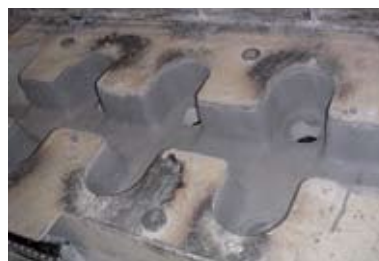
Gießtisch für die Aluminiumbillet-Produktion, beschichtet mit EKamold Cast-C vor dem Einsatz
