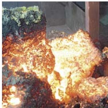
Glühender Titandiborid-Ofenkern als Teilprozess der TiB 2 -Produktion bei ESK
