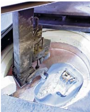
Anwendungsbild von der neuen wasserbasierten Schlichte EKamold Cast-M für metallische Untergründe (z.B. Gießlöffel) in einem Produktionsbereich der Nemak Linz GmbH in Österreich
