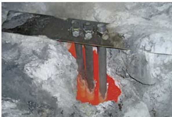
Drei Thermoelementschutzrohre aus ESK Titandiborid in der Aluminiumschmelze, aufgenommen in einer Produktionsstätte von Hydro
